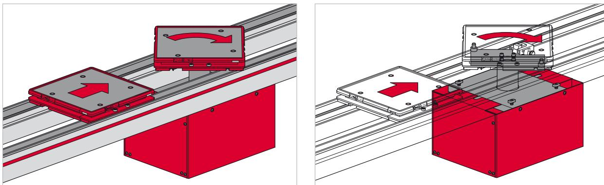
Die Wendeeinheit WE wird eingesetzt, wenn Werkstückträger für bestimmte Operationen gedreht werden müssen. So kann bei Systemen ohne Umlenkführungen die gleichbleibende Laufrichtung eines Werkstückträgers, nach dem Übersetzen auf eine parallele Bahn, wieder hergestellt werden.
