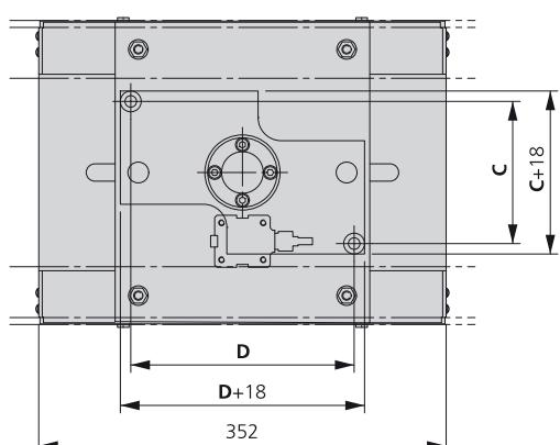
**P** = Luftanschluss / Raccordement d'air / Air connection
