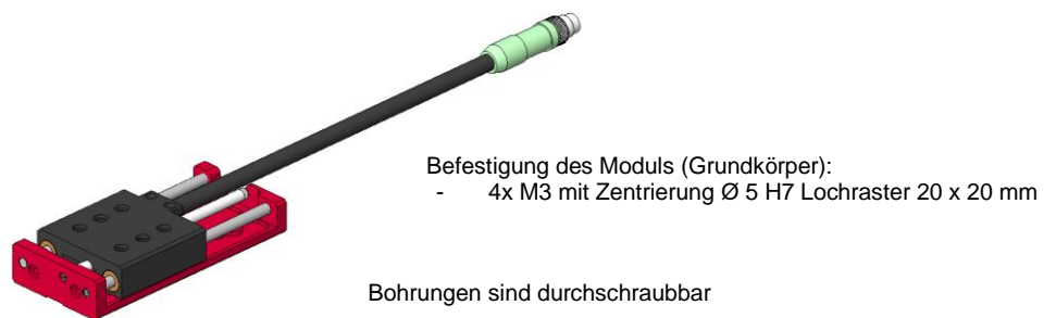
Abb. 9 Elektroschlitten ES (Befestigung Grundkörper)
