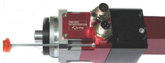
2. Defektes Modul RE-50 entfernen.
