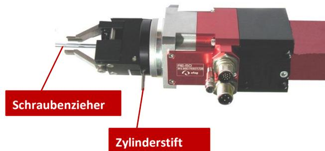
4. Klemmschraube an der Greifzange lösen:
