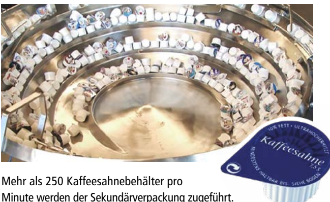
Flexible Zuführkomponenten wie der aflex ermöglichen die Vereinzelung von Teilen verschiedener Geometrien und sind durch kurze Umrüstzeiten für vielseitige Anwendungen geeignet.
