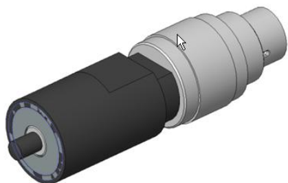
Figure 25: Interrupteur desserrage de frein SE-24
